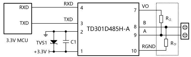
图 2.MCU 3.3V 供电应用电路
