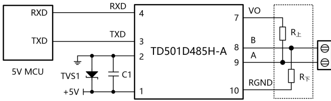
图 1.MCU 5V 供电应用电路
